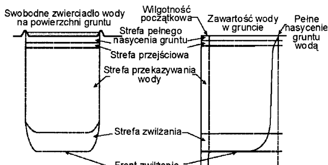
Rys. 1. Schemat przemieszczania się wody w gruncie o niepełnym nasyceniu wodą [10]
