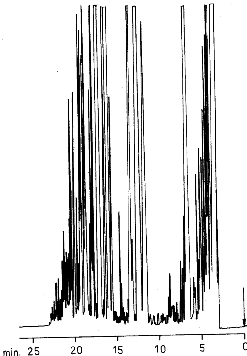
Rys. 6. Chromatogram wody destylowanej zawierającej 2 \cdot 10^{-5} \text{ g/dm}^3 benzyny (20 ppm)
