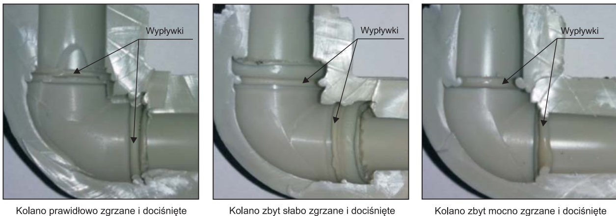
Rys. 4. Trzy rodzaje kolan z polipropylenu z widocznymi wypływkami powstałymi podczas dociskania zgrzewanych elementów Fig. 4. Three types of polypropylene elbows with the flashes formed while pressing the welded elements
