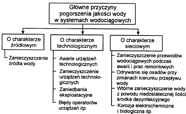
Rys. 1. Schemat blokowy głównych przyczyn pogorszenia jakości wody
