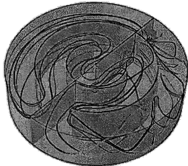
Rys. 3. Tory cząstek wody przemieszczającej się w komorze kontaktowej wody z chlorem [4]
