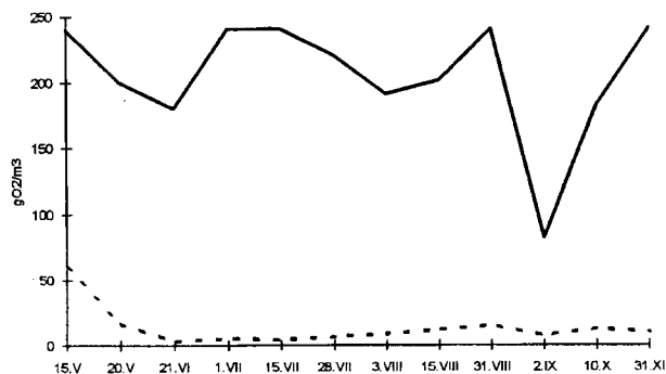
Rys. 4. Zmiany BZT 5 ścieków (linia ciągła – ścieki surowe, linia przerywana – ścieki oczyszczone)
