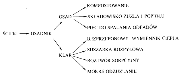
Rys. 3. Schemat gospodarki ściekowej w spalarni odpadów
